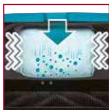
Filtro polveri con scuotimento elettrico
