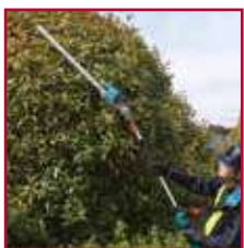
Testina tagliasiepi ad angolazione regolabile
